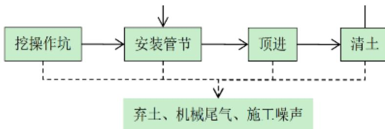
图 3-5 顶管穿越施工工艺流程及产排污环节图
