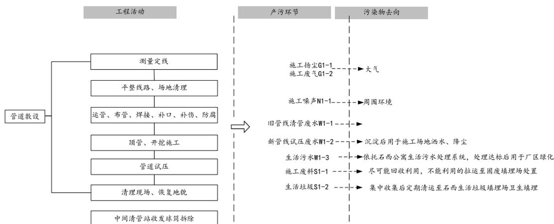
图 3-7 施工期工艺流程及产排污节点图
