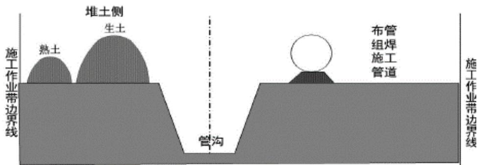
图 3-4 开挖施工方式断面示意图
