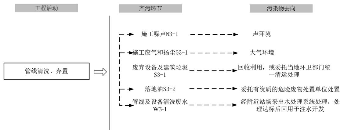
图 3-8 项目退役期主要工艺流程及产污环节示意图
