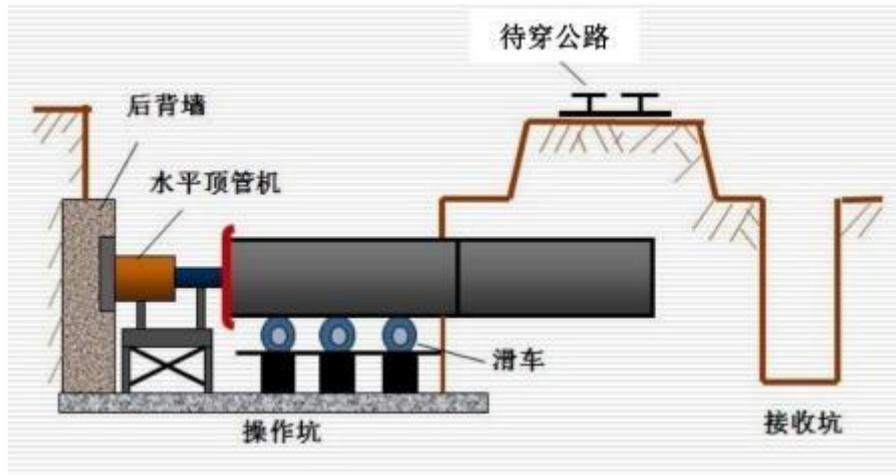
图 3-6 顶管穿越示意图
