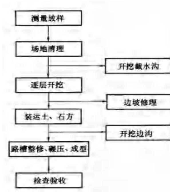
图 3.3-3 挖方路基施工流程图
